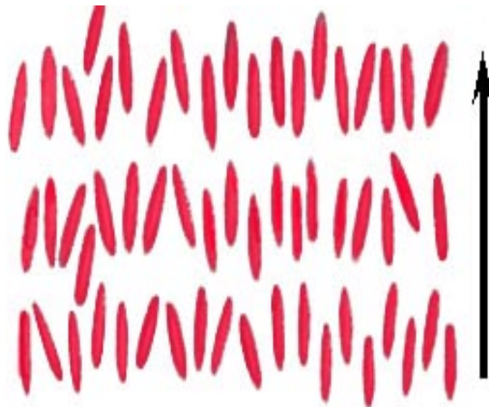
Figura 1.8: Esquema gráfico do alinhamento e da estrutura das moléculas para a fase esmétrica-A.
