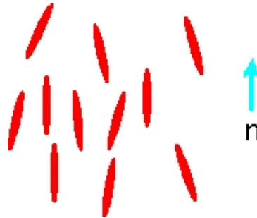
Figura 1.6: Esquema representativo da fase nemática.
