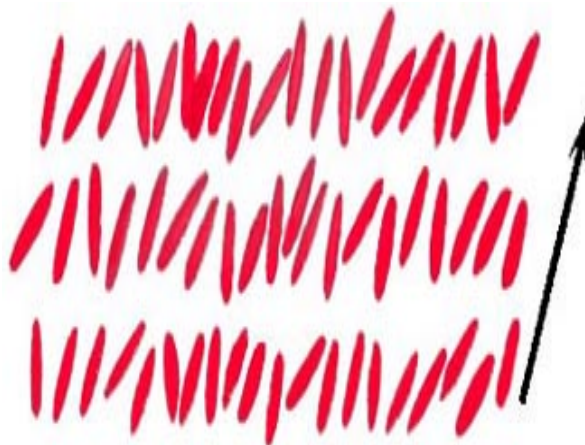
Figura 1.9: Esquema gráfico do alinhamento e da estrutura em camadas das moléculas para a fase esmética-C.
